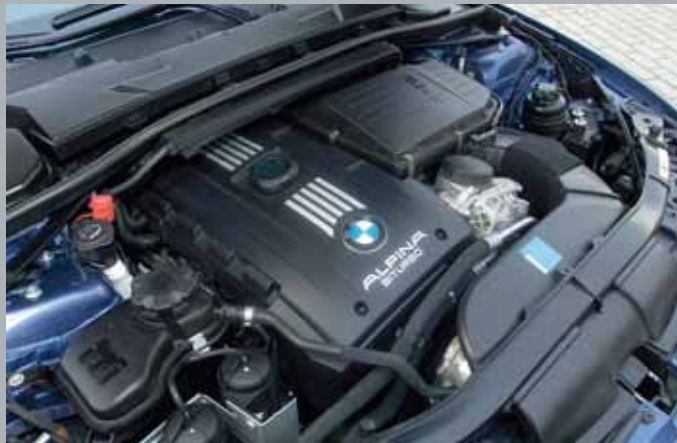
Le 6 cylindres de 360 ch et 500 Nm s'accorde particulièrement bien à la transmission automatique. Un duo détonnant!
